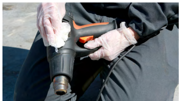
Varmluftspistol torkas av med ytdesinfektion.
